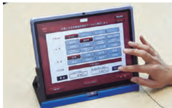
普段使っている社員証を端末認証にも利用。カスタマイズでFeliCaリーダーを背面に内蔵した。カードが落ちないよう、カバー背面にはガイドとなるリブが付いている。
