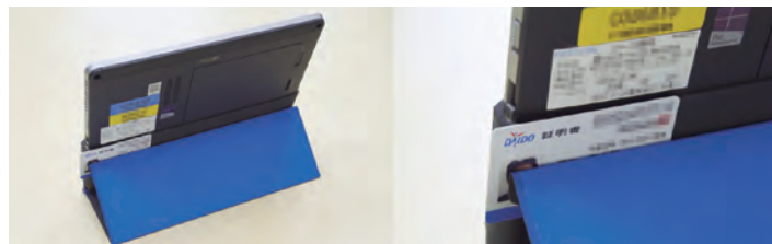
普段使っている社員証を端末認証にも利用。カスタマイズでFeliCaリーダーを背面に内蔵した。カードが落ちないよう、カバー背面にはガイドとなるリブが付いている。
