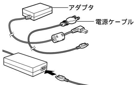
**6** 電源ケーブルを DC-IN コネクタに接続します。
