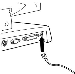
**8** 電源ケーブルとアース線をコンセントに接続します。
