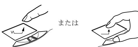
マウスポインタを任意の位置に移動し、操作面を素早く2回タップします。2回目のタップのときに指を操作面上から離さないで、希望の位置まで操作面をなぞり、指を離します。または、マウスポインタを任意の位置に移動し、左ボタンを押しながら希望の位置まで操作面をなぞり、指を離します。
