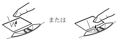
操作面を2回連続してタップするか、左ボタンをカチカチッと2回素早く押して、すぐ離すことです。ダブルクリックの速度は、「マウスのプロパティ」ダイアログボックスで調節できます。
