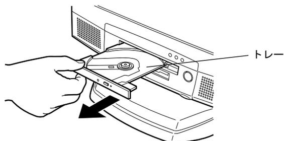
**3** CDのレーベル面を上にして、トレーの中央の突起に「パチン」という音がするまではめ込みます。
