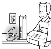
周辺機器の取り付けや取り外しを行うときは、パソコン本体および接続されている機器の電源を切り、電源プラグをコンセントから抜いた後に行ってください。
