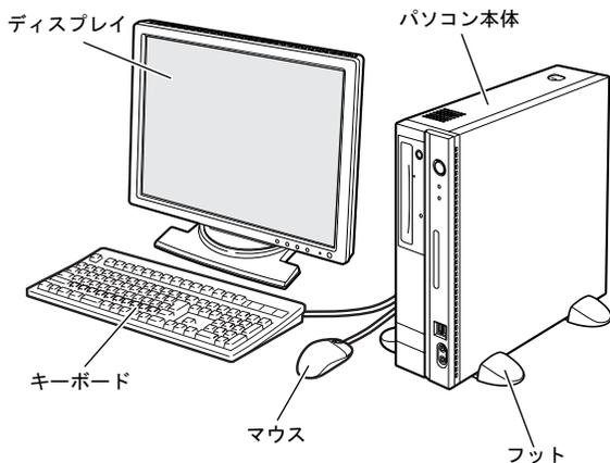
本パソコンを壁などに接して縦置きにする場合、壁などに接していない片側だけフットを取り付けます。
