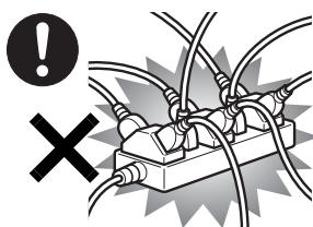
ACアダプタの電源プラグは、壁のコンセント(AC100V)に直接かつ確実に差し込んでください。また、タコ足配線をしないでください。
