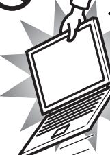
本装置を持ち上げたり運んだりする場合、液晶ディスプレイや液晶ディスプレイの枠部分を持って、装置を持ち上げたり運んだりしないでください。
