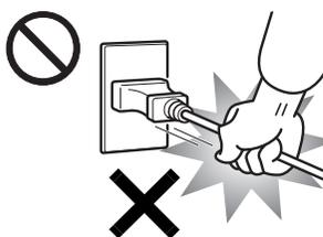
ACアダプタの電源プラグを抜くときは、電源コードを引っ張らず、必ず電源プラグを持って抜いてください。
