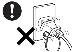
ACアダプタや電源プラグは、コンセントの奥まで確実に差し込み、不完全な接続状態で使用しないでください。
