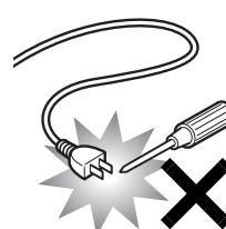
ACアダプタの電源プラグに、ドライバーなどの金属を近づけないでください。火災・感電の原因となります。
