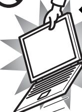
本装置を持ち上げたり運んだりする場合、液晶ディスプレイや液晶ディスプレイの枠部分を持って、装置を持ち上げたり運んだりしないでください。
