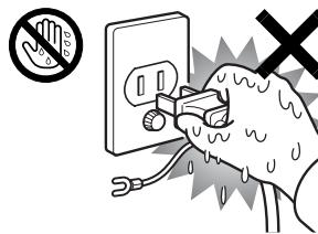
濡れた手で電源プラグを抜き差ししないでください。感電の原因となります。
