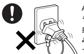
ACアダプタや電源プラグは、コンセントの奥まで確実に差し込み、不完全な接続状態で使用しないでください。
