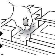
本パソコンの内部に搭載されているリチウム電池には触らないでください。
