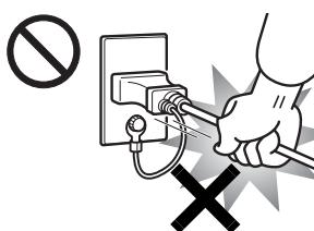
電源プラグを抜くときは電源ケーブルを引っ張らず、必ず電源プラグを持って抜いてください。
