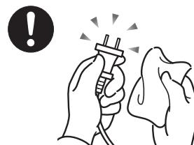
ACアダプタや電源プラグはコンセントからときどき抜いて、コンセントとの接続部分およびACアダプタと電源コードの接続部分などのほこりやゴミを乾いた布でよく拭き取ってください。
