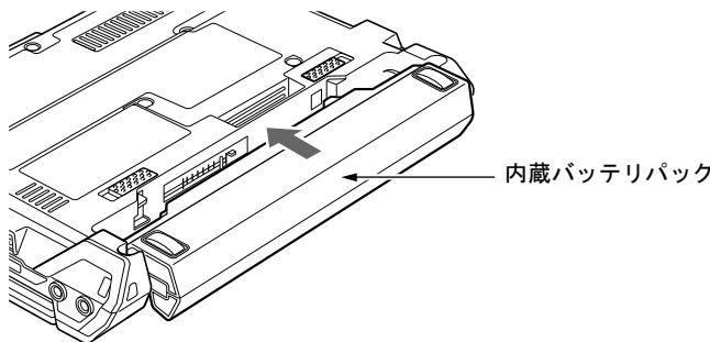
**6 内蔵バッテリパックロック 1 を矢印の方向にスライドさせ、内蔵バッテリパックをロックします。**
