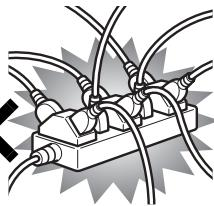
ACアダプタの電源プラグは、壁のコンセント(AC100V)に直接かつ確実に差し込んでください。また、タコ足配線をしないでください。
