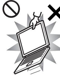
本装置を持ち上げたり運んだりする場合、液晶ディスプレイや液晶ディスプレイの枠部分を持って、装置を持ち上げたり運んだりしないでください。
