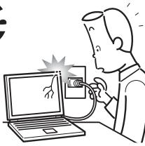
本製品を落としたり、カバーなどを破損したりした場合は、パソコン本体の電源を切り、ACアダプタの電源プラグをコンセントから抜いてください。バッテリパックを装着している場合は、バッテリパックも取り外してください。
