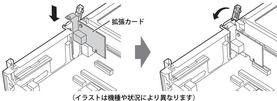
**5 ネジを締めて拡張カードを固定します。**
