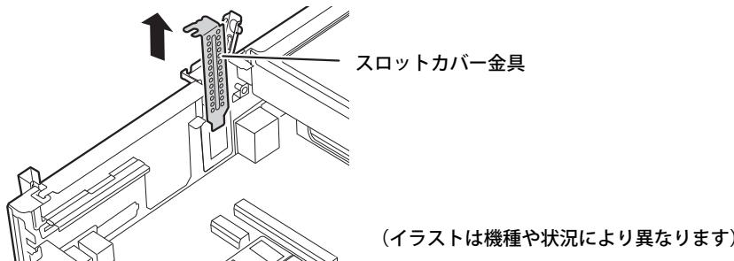
**4 拡張カードを取り付け、スロットカバーロックを倒します。**
