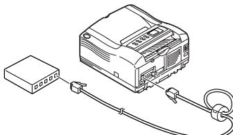
プリンタ LAN カード取り付け後、プリンタ背面に LAN ケーブルを差し込み、ネットワーク環境の設定を終えると本プリンタをネットワークプリンタとして使用できます。なおネットワーク環境の設定は、プリンタ側およびパソコン側で必要となります。詳細は、XL-2300G 添付の CD-ROM 内に格納されているネットワークガイド（F:\Manual\NetworkGuide.pdf）を参照してください。（CD-ROM ドライブが F の場合）
