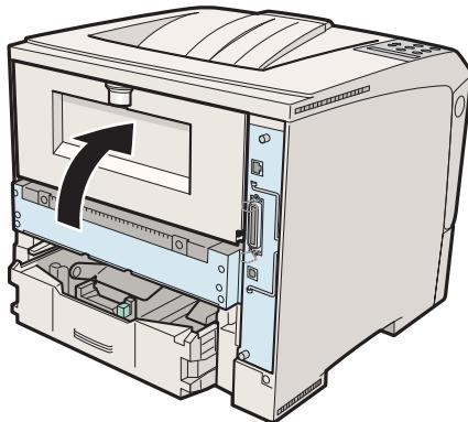
**9 オプションの拡張給紙ユニットを取り付けている場合は、カセットを引き出して、用紙の搬送部分に詰まった用紙がないか確認します。**
