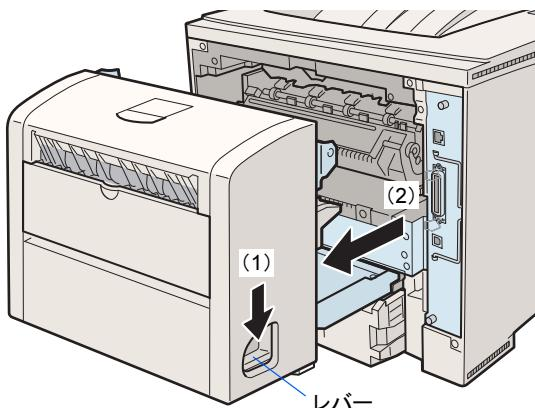
2. (1) 両面ユニットの底板にあるレバーを押しながら、(2) 両面ユニットを引き抜きます。
