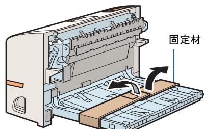
**3** 紙給料カセットカバーを取り付けている場合は、(1) 紙給料カセットカバーの下部を少し引き上げ、(2) 本体背面から取り外します。
