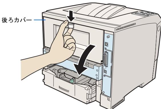
2. 後ろカバーを水平方向に取り外します。
