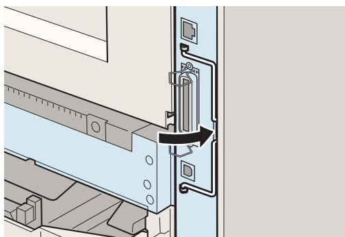
**10** ネジ（2ヶ所）でコントローラボードを固定します。
