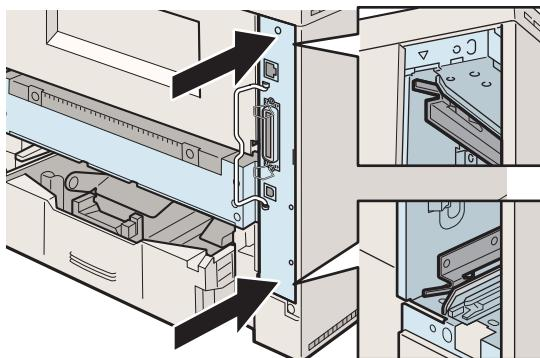
**9** コントローラボードの取っ手を、カチッと音がする位置まで倒し、固定します。
