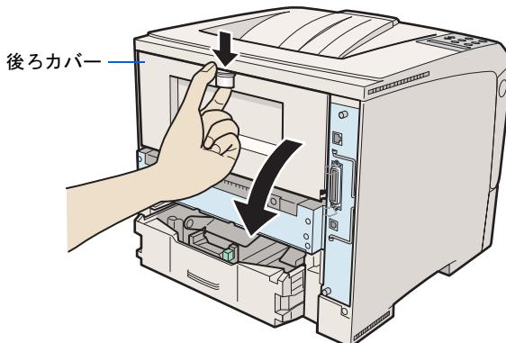
**5** 後ろカバーを水平方向に取り外します。
