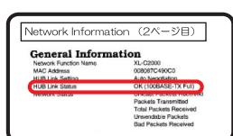
**4** オペレータパネルの管理者用メニューの【ネットワークメニュー】－【ハブトノセツゾク】をハブユニットの Ethernet タイプに合わせて設定し直す
