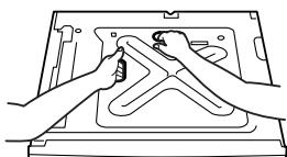
拡張給紙ユニット-A(1トレイ)の正面に立ち、図の左右の穴に手を入れて、1人で持ち上げます。
