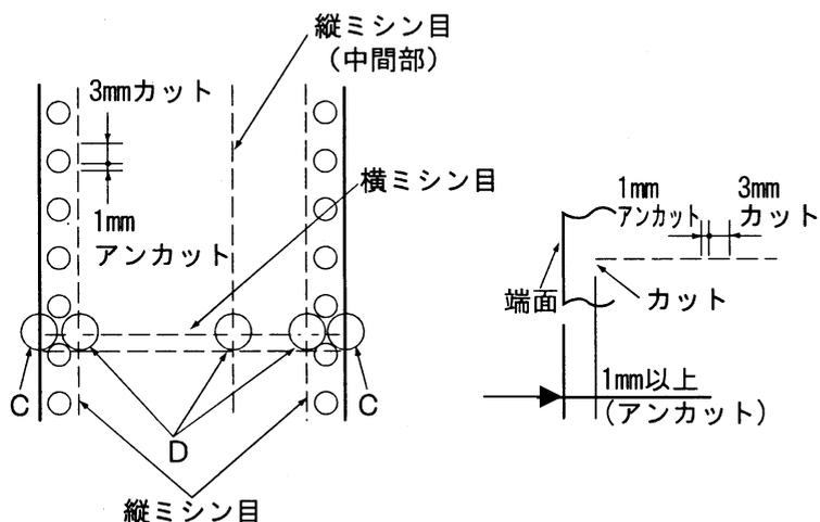
注1) ミシン目上に印字すると、用紙にキズがついたりプリンタの故障となることがありますので、下の図に示す斜線部には印字しないでください。
