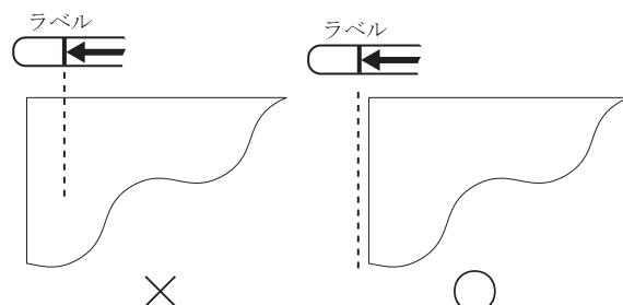
注) プリンタのラベル←部（「単票セットフリー」の用紙セット範囲）付近に用紙をセットする場合、用紙ガイドと単票テーブルの隙間に用紙の先端がもぐり込む場合がありますので注意してください。
