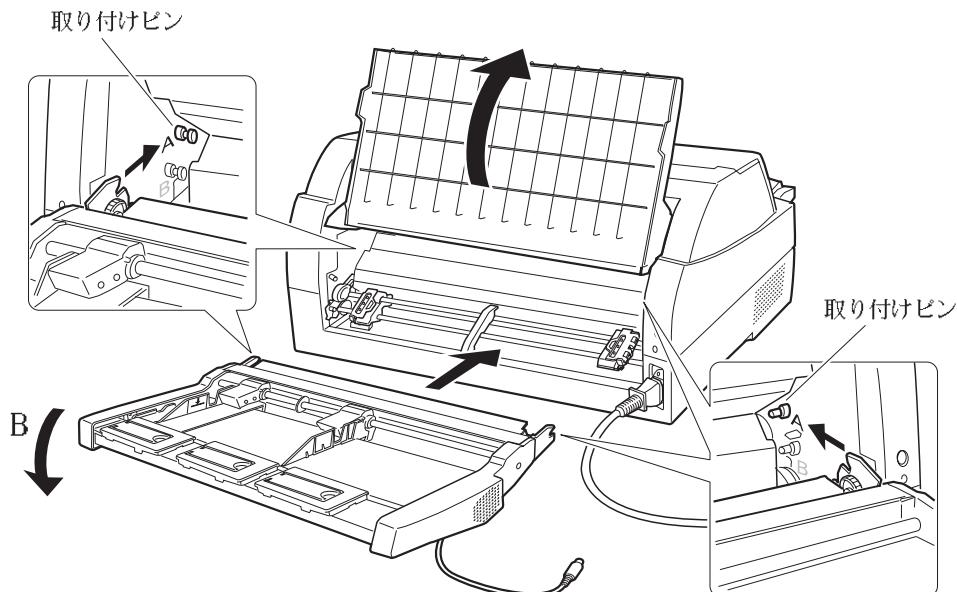
取り付けピン 2 にカットシートフィーダのフレームが正しく乗っていることを確認してください。
