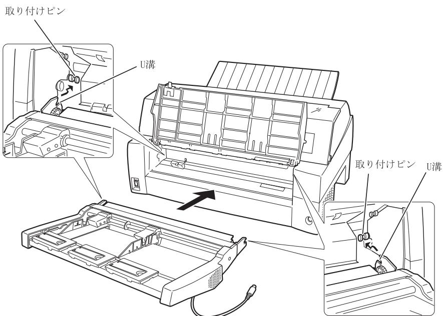
取り付けピン2にカットシートフィーダのフレームが正しく乗っていることを確認してください。
