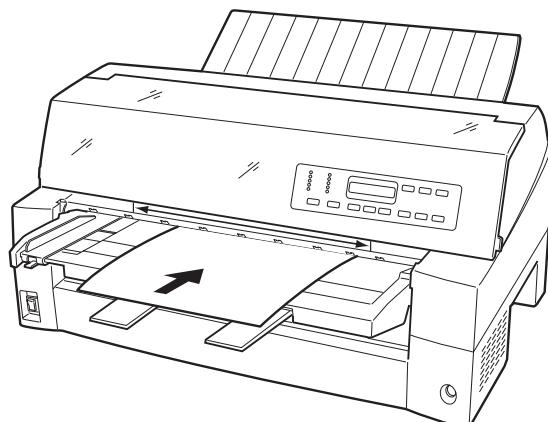
注1) サブガイドを引き出して使用する場合は、上図のように2つのサブガイドの上に用紙を乗せ、サブガイドの長い辺から用紙がはみ出さないようにセットしてください。サブガイドからはみ出した状態で用紙をセットすると、用紙の端がサブガイドに引っかかり、正しく吸入されない場合があります。
