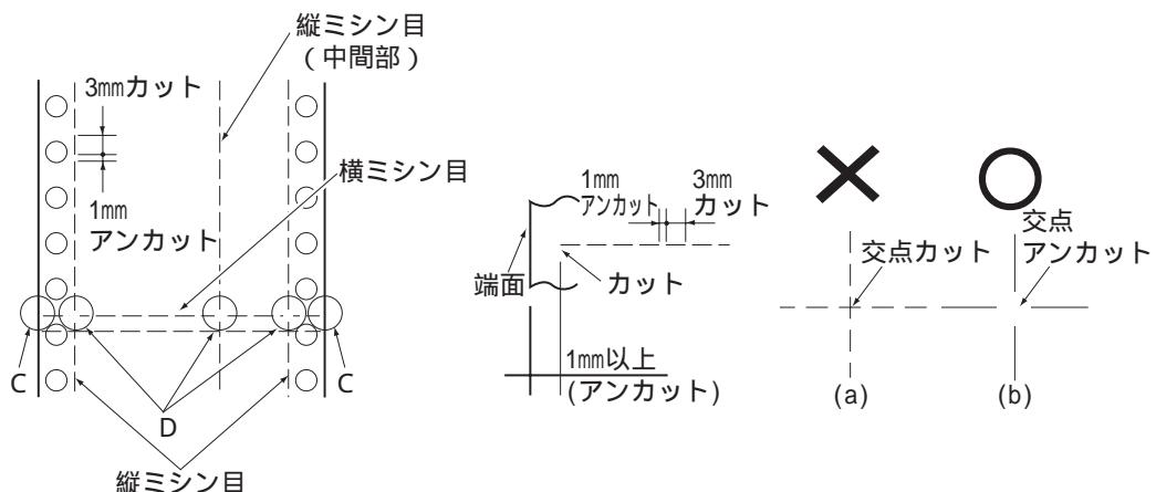
注) ミシン目上に印字すると、用紙にキズがついたりプリンタの故障となることがありますので、下の図に示す斜線部には印字しないでください。
