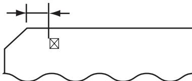
左端部の面取は第 1 ドットの左側となるように用紙ガイドを移動して使用してください。
