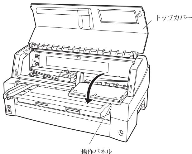
**5 トラクタの左右の用紙押さえを開き、トラクタから用紙を外す**
