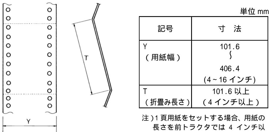
注) 1頁用紙をセットする場合、用紙の長さを前トラクタでは 4 インチ以上、後トラクタでは 5 インチ以上にしてください。
