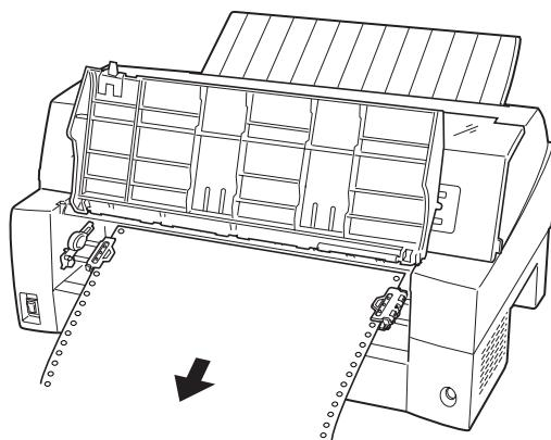
用紙が印字部につまってうまく取り除けない場合や、小さな紙片が残ってしまった場合は、用紙を取り除きやすいように印字ヘッドを適当な位置に手で動かし（下図参照）、残った用紙を手で取り除きます。また、印字ヘッド先端付近の用紙が取り除きにくい場合は、リボンカセットを取り外してから用紙を取り除きます（取り除きにくい場合はピンセットなどを使用してください）。
