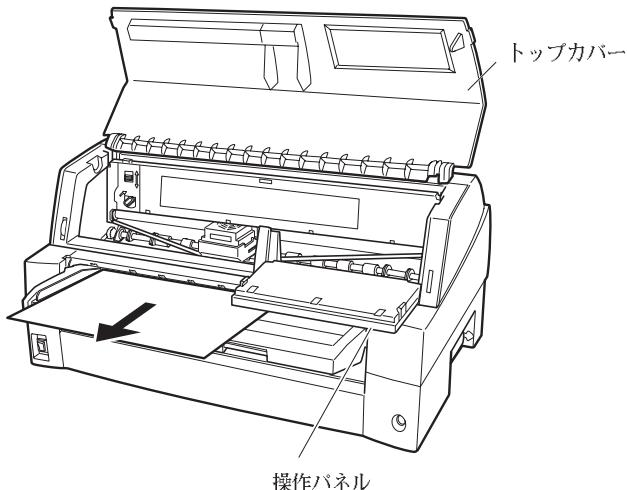
用紙が印字部につまってうまく取り除けない場合や、小さな紙片が残ってしまった場合は、用紙を取り除きやすいように印字ヘッドを適当な位置に手で動かし、残った用紙を手で取り除きます。また、印字ヘッド先端付近の用紙が取り除きにくい場合は、リボンカセットを取り外してから用紙を取り除きます（取り除きにくい場合はピンセットなどを使用してください）。
