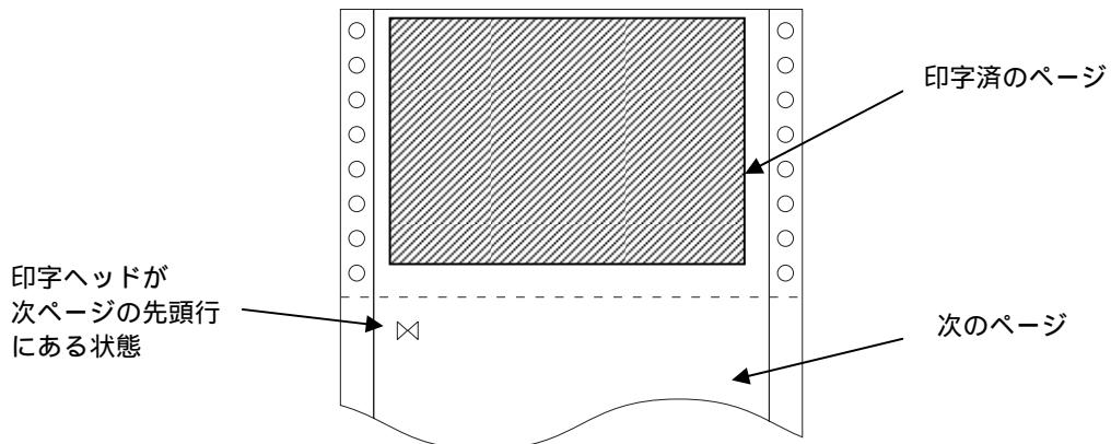
注) ページ長設定が正しくないとき、および **微小改行** スイッチで用紙を移動させた場合は、カット位置が合わなくなります。
