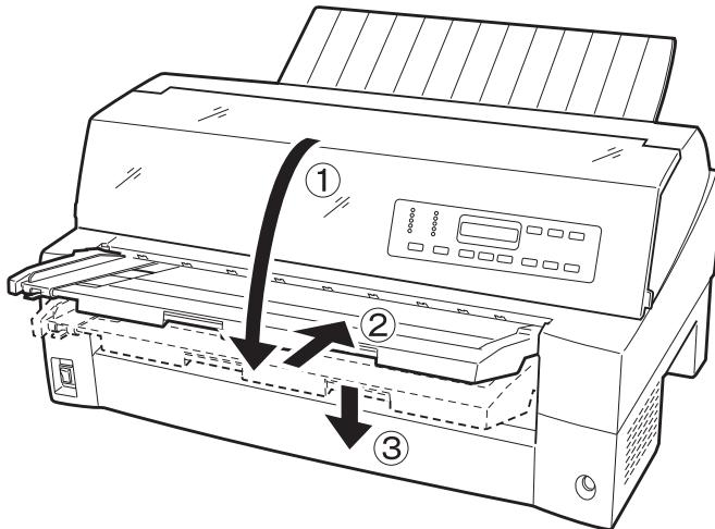
セット完了状態は下図のように、単票テーブルの先端がプリンタのガイドピンに挿入され单票テーブルのガイドピンがカバーの溝に入っていることを確認してください。
