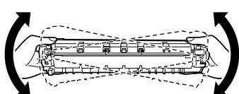
保護シャッターを止めているテープを上から下方向にはがし、トナーシールをゆっくり引き抜きます。
