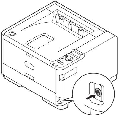
電源が入ると電源スイッチのLEDランプが点灯します。
