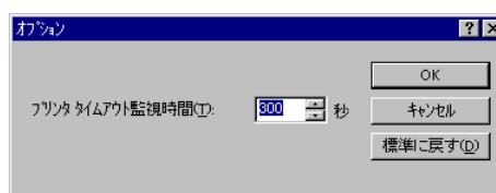
プリンタタイムアウト監視時間 .... プリンタ装置からの応答を待ち合わせる監視時間を、60 ~ 7200秒の範囲で設定します。ここで指定した時間プリンタから何も応答がないときは、ネットワークが切断されているとみなし、エラーを通知します。
