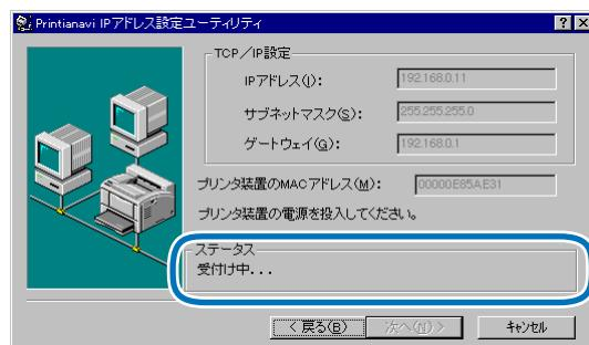
電源スイッチを「/」側に倒して、プリンタの電源を入れる
