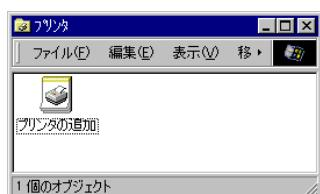
2 マイコンピュータの〔プリンタ〕をダブルクリックし、〔プリンタの追加〕をダブルクリックする
