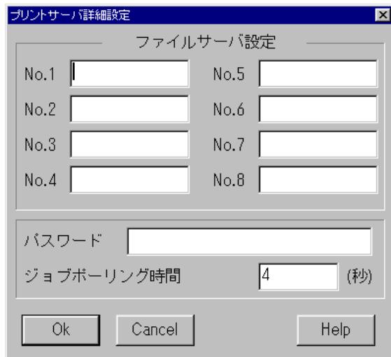
ファイルサーバ設定 ... 接続されるファイルサーバを、半角の英数字 31 文字以内で設定します。
