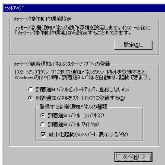
7 「メッセージ操作動作環境設定」と、「メッセージ到着通知パネルのスタートアップへの登録」の設定を確認し、[次へ]をクリックする
