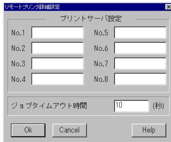
プリントサーバ設定 ... 接続されるプリントサーバを、半角の英数字 31 文字以内で設定します。
