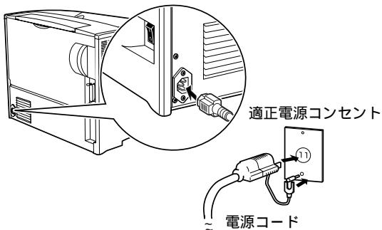
電源スイッチを「|」側に倒して、電源を投入します。
