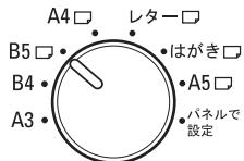
「パネルで設定」の位置に設定すると、プリンタ ドライバまたはオペレータパネルで設定したサイズが有効となります。
