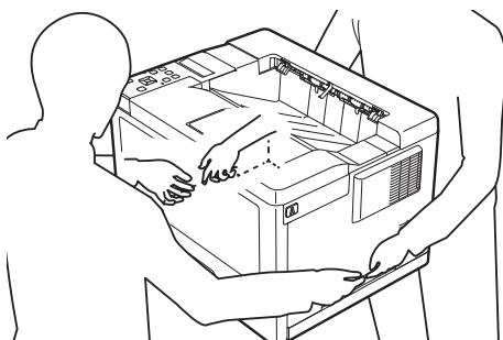
**14** 拡張給紙ユニットのガイドピン**4ヶ所**がプリンタ底面の穴に入るようゆっくりと下ろします。
