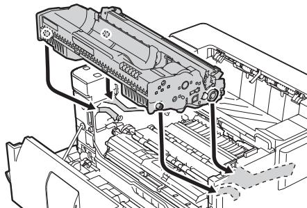
**13** 古いドラムカートリッジにセットされたトナーカートリッジのロックバーを奥側に突き当たるまで倒してロックを解除します。
