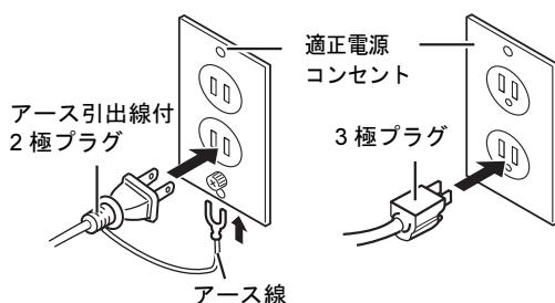
本製品に添付されている電源コードの電源プラグは「アース引出線付 2 極プラグ」と「3 極プラグ」の 2 種類です。このマニュアルでは「電源プラグ」と表記しています。コンセントの形状に合わせてご使用ください。
