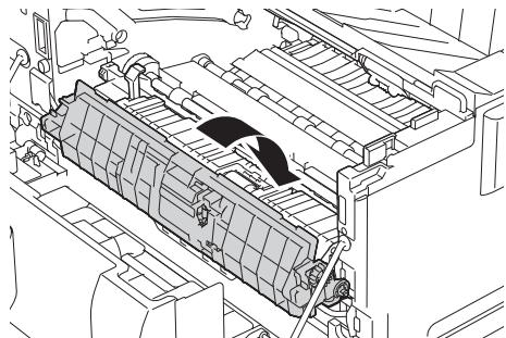
**6** ドラムカートリッジの取っ手を両手で持ち、左右にある突起をプリンタ本体の溝に合わせて、しっかりと押し込みます。
