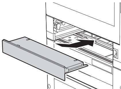
**20** プリンタ本体に給紙カセット1の手前側を持ち上げて差し込み、奥までゆっくりと押し込みます。
