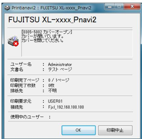
双方向プリンティングシステム「Printianavi2」を利用してことで FUJITSU Printer XL シリーズプリンタの状態表示、印刷中止、印刷完了通知などの統合的な管理をパソコンで行うことができます。
