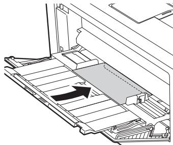
フラップを閉じて、印刷面を上にして封筒の上辺を奥側にセットします。
