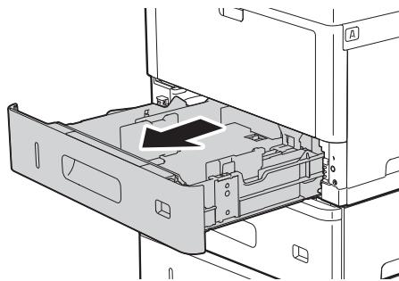
**16** 紙力セット 1 の両側を両手で支え、紙力セットの手前側を少し上げて引き抜きます。
