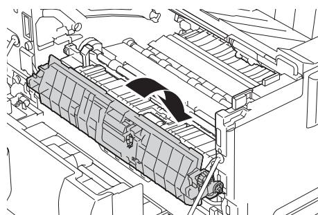
**10** ドラムカートリッジの取っ手を両手で持ち、左右にある突起をプリンタ本体の溝に合わせて、しっかりと押し込みます。
