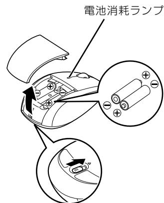
ワイヤレスマウスは、乾電池を入れたときに電池消耗ランプが約10秒間緑色に点灯します。
