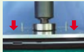
LCD天板からの全面加圧試験 （200kgfを再現して実施）
