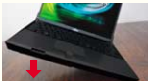
パソコン動作時の片持落下試験
