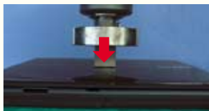
天板からの一点加圧試験 (約35kgfを再現して天板全体に実施)
