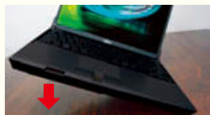
パソコン動作時の片持落下試験
