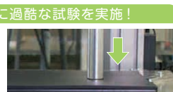
天板からの1点加圧試験
