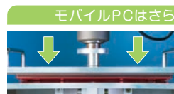
天板からの全面加圧試験
