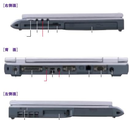
音量ボリューム ヘッドフォン・ジャック ラインイン・ジャック/光デジタルオーディオ出力端子 マイクイン・ジャック FDドライブ CD-ROM(またはCD-RW/DVD、CD-R/RW)ドライブ 拡張キーボード/マウス パラレル IEEE1394 USB S端子 外部ディスプレイ FAXモード シリアル DC-IN MAINスイッチ PCカードスロット
