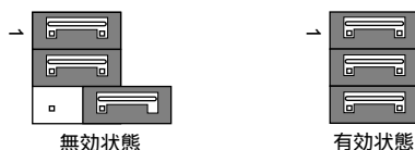
図2-2.SCSI終端抵抗設定スイッチ(CNH1)の設定
