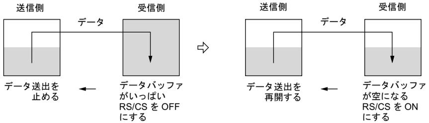
これによって、モデムポートの通信速度が接続相手によって変わったとき、シリアルポートの速度を変更しなくても、データ抜けを起こさず確実に通信することができます。
