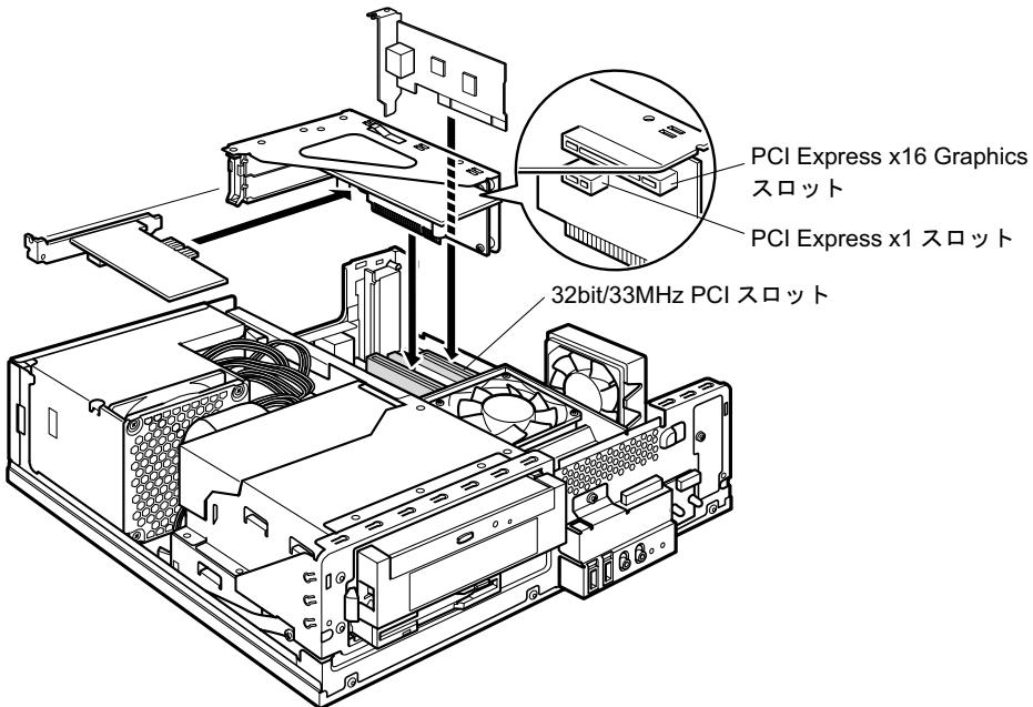
本ワークステーションには、PCI Express x1 規格と PCI 規格の拡張カードを取り付けられます。PCI Express x1 スロットには、最大長 176mm の拡張カード（ハーフサイズ）を取り付けることができます。拡張カードスロットには、最大長 176mm の Low Profile 用 PCI 規格の拡張カード（ハーフサイズ）を取り付けることができます。
