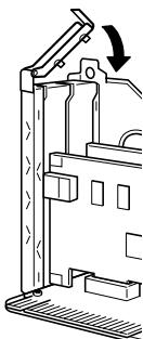
**9 拡張カード取り付け金具を取り付けます。**
