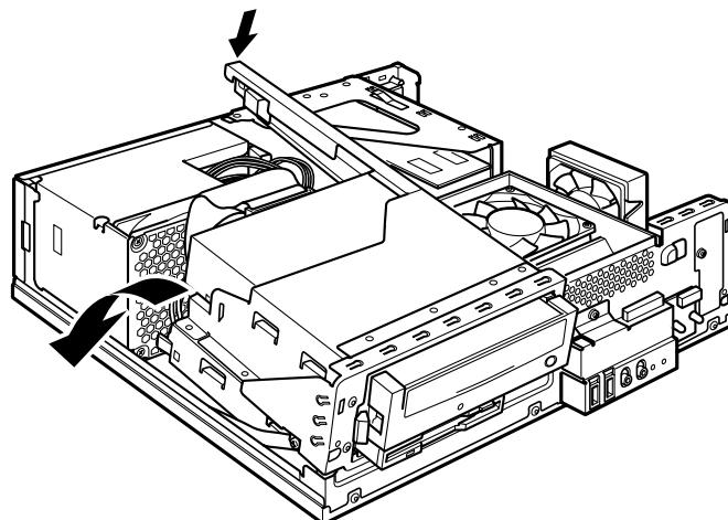
**11 本体力バーを取り付けます。****12 縦置きにする場合は、フットを取り付け、ワークステーション本体を縦置きにします。**
