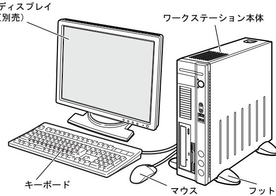
本ワークステーションを壁などに接して縦置きにする場合、壁などに接していない片側だけフットを取り付けます。
