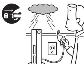
雷が鳴り出したときは、落雷の可能性がなくなるまでワークステーション本体やケーブル類に触れないでください。ケーブル類の接続作業は、落雷の可能性がなくなるまで行わないでください。
