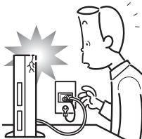
本製品を落としたり、カバーなどを破損したときは、ワークステーション本体の電源を切り、電源プラグをコンセントから抜いてください。
