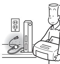
周辺機器の取り付けや取り外しを行うときは、ワークステーション本体および接続されている機器の電源を切り、電源プラグをコンセントから抜いたあとに行ってください。
