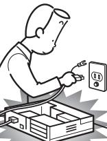
本体カバーを外した状態で電源プラグをコンセントに差し込んだり、電源を入れたりしないでください。
