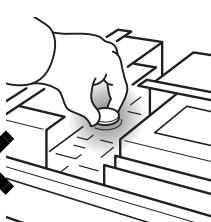
本ワークステーションの内部に搭載されているリチウム電池には触らないでください。
