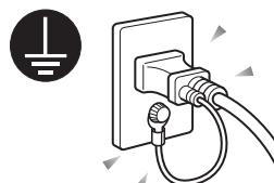
電源プラグをコンセントに差し込む前に、必ずアース線をコンセントのアースネジへ接続してください。
