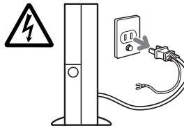
メモリの取り付けや取り外しを行うときなど、本体力バーをあける場合は、ワークステーション本体および接続されている機器の電源を切り、電源プラグをコンセントから抜いた後、しばらく経ってから本体力バーを開けてください。また、モデム搭載機種で電話回線からモジュラーケーブルが接続されている場合、モジュラーケーブルも取り外してください。
