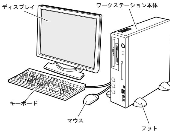
本ワークステーションを壁などに接して縦置きにする場合は、壁などに接していない片側だけフットを取り付けます。
