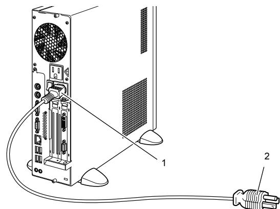
1 電源ケーブルのプラグをワークステーション本体背面のインレットに接続します。
