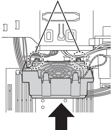
**13 (1) CPU0ダクトとFan5: HDD FANの接合部を合わせ、(2) ゆっくり下ろして取り付けます。**
