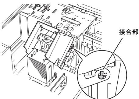
**10** Fan5: HDD FANのツメ（2ヶ所）を持ち上げながら矢印の方向に倒して取り外し、そのまま上に置きます。
