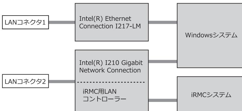
図1) CELSIUS C740のLANコントローラーとLANコネクタの接続体系
