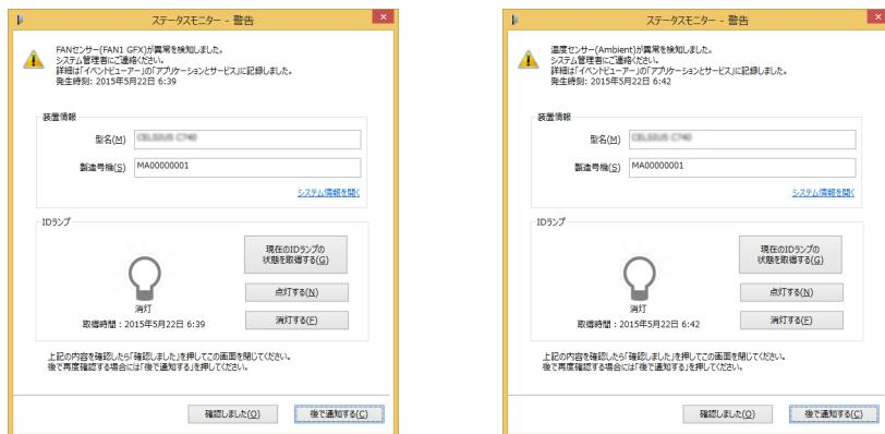
異常を検知したデバイスの情報を通知するとともに、Windowsのイベントログに検知したセンサーと時間などを記録します。
