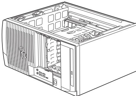
2. イラストのように、取り付けるハードディスクの端子側を奥にして、ストレージベイの奥まで差し込み、ハードディスク固定レールのフックを内側に倒します。イラストは、内蔵ストレージベイ1です。他のベイも同様の取り付け手順になります。
