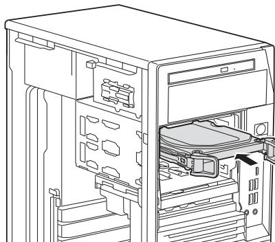
2. ハードディスク固定レールのフックを内側に倒します。
