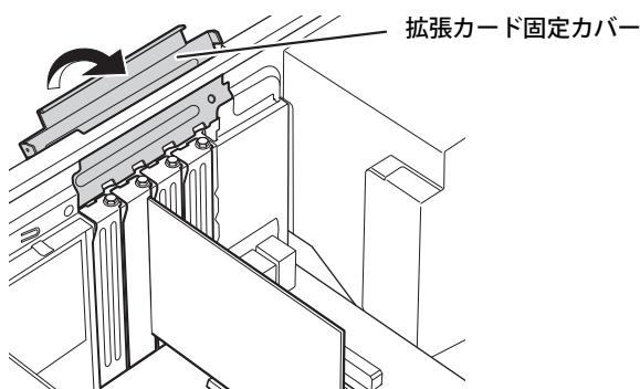
**9 拡張カード固定カバーをワークステーション本体背面のネジで固定します。**
