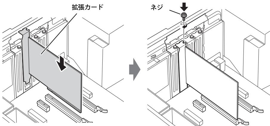
**8 拡張カード固定カバーを元の位置に戻します。**
