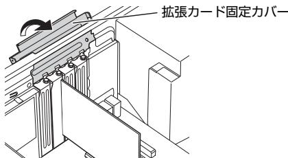
**9 拡張カード固定カバーをワークステーション本体背面のネジで固定します。**
