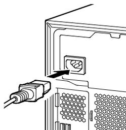
2 電源ケーブルの電源プラグをコンセント (AC100V) に接続します。
