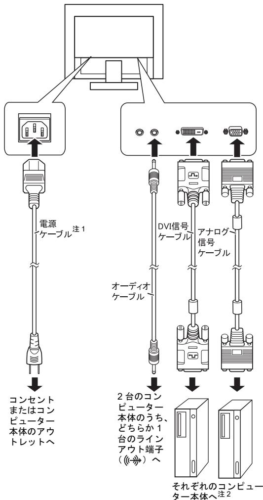
注1：製品には、同梱されている電源ケーブルを使用してください。また、電源ケーブルは他の製品には使用しないでください。
