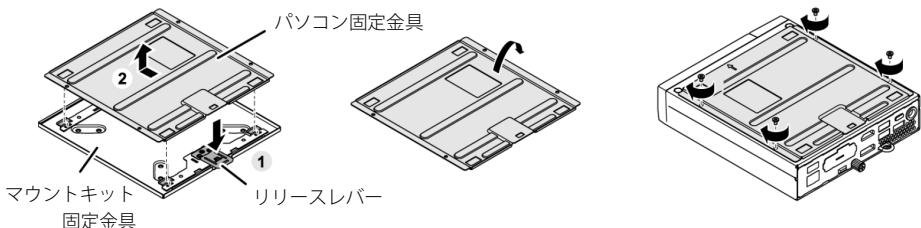
2 ディスプレイマウントキット本体に、マウントキット固定金具をネジ（中4）で取り付けます。
