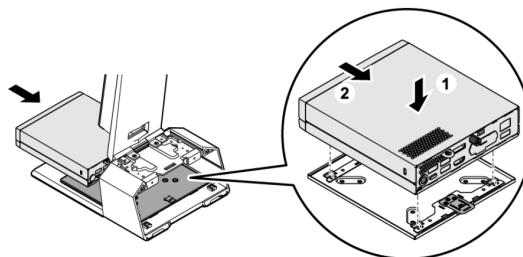
再度パソコン本体を取り外す場合は、マウントキット固定金具のリリースレバーを押しながら、パソコン本体を前面にスライドさせて取り外してください。
