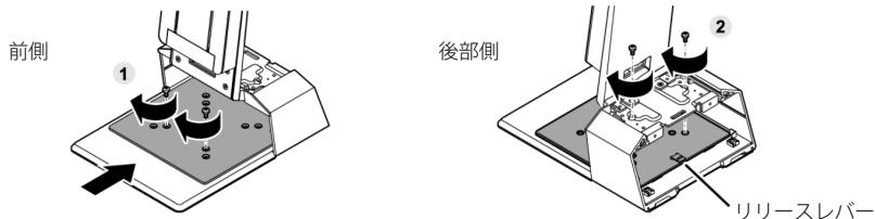
3 パソコン固定金具を下側にして、パソコン本体をマウントキット固定金具に取り付けます。
