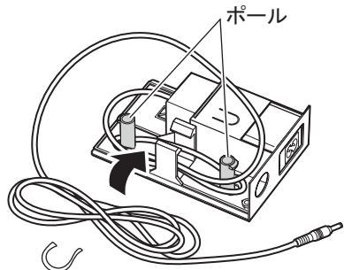
7 ACアダプタのケーブルを、ACアダプタ取り付けユニット2の正面の丸い穴から外に出します。
