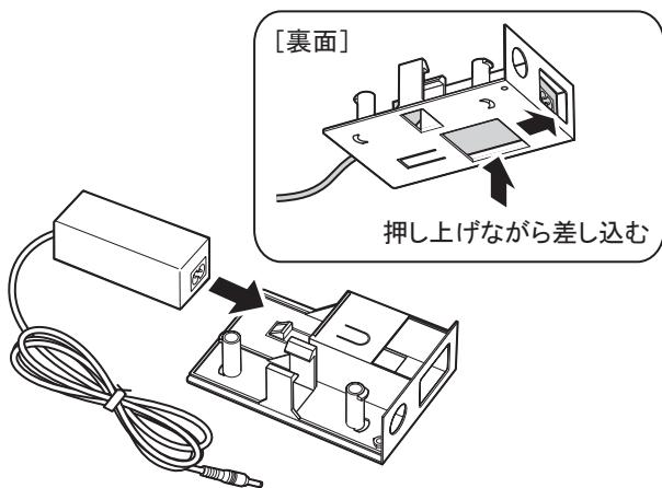
6 ACアダプタのケーブルの不要な部分を ACアダプタ取り付けユニット2のポールに巻き付けます。
