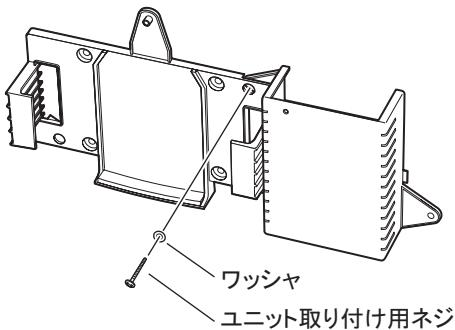
3. もう一方の突起部のネジ穴をネジ止めします。
