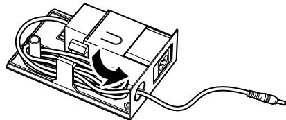
8 ACアダプタをセットしたACアダプタ取り付けユニット2を、図のよう<sup>に</sup>ACアダプタ取り付けユニット1に差し込みます。
