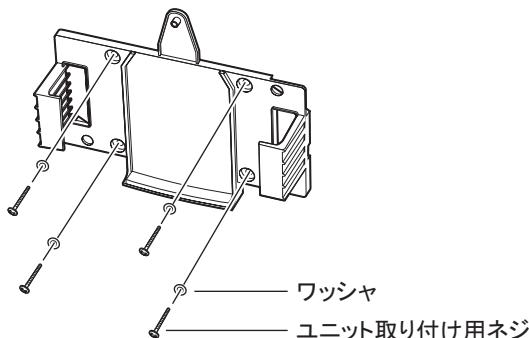
AC アダプタを設置しない場合（設置パターン 3）は、次に手順 3 に進みます。
