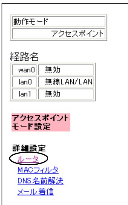
「ルータ設定」画面の「本体」では「ルータの LAN0 アドレス」は接続している有線 LAN のネットワークアドレスのうち使用されていないものを設定します。
